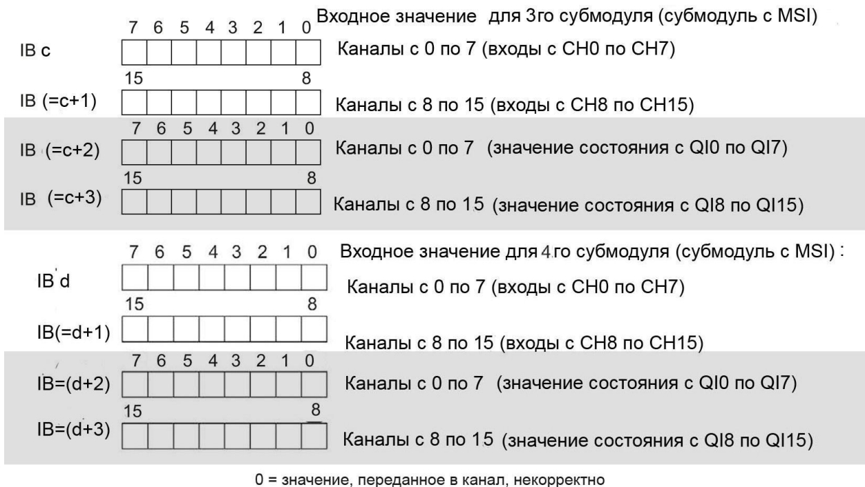
Рисунок 4-4 Пространство адресов при конфигурации модуля DI 16x24VDC BA MSI в режиме совместного доступа 1x16-канального входа, с оценкой состояния.
