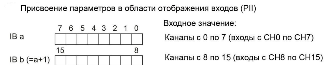
Рисунок 4-1 Пространство адресов для конфигурации модуля в режиме 1x16-канального входа DI 16x24VDC BA
